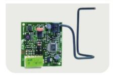
• Receptores de acoplamiento con conector Molex de 5 pin compatible con equipos Genius equipados con acoplamiento de 5
